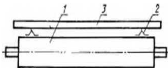
Рис.2 Схема измерения прямолинейности образующей цилиндрической поверхности контактных валцов
