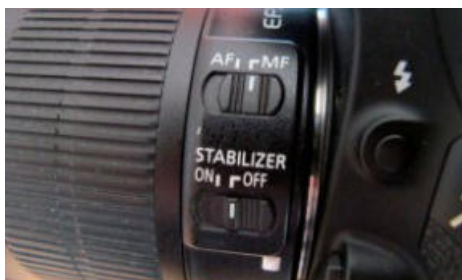
Рисунок 13 – Отключение стабилизации изображения
